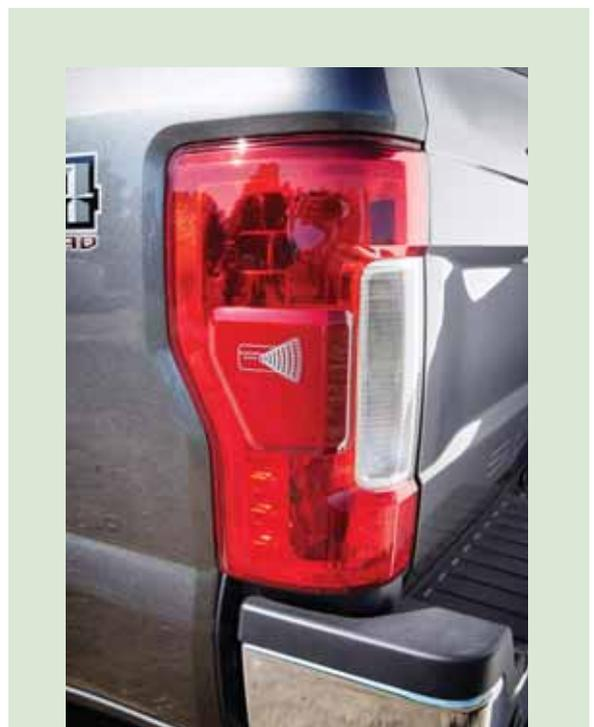
Le système d'angle mort BLIS est intégré aux feux arrière du Ford Super Duty.
